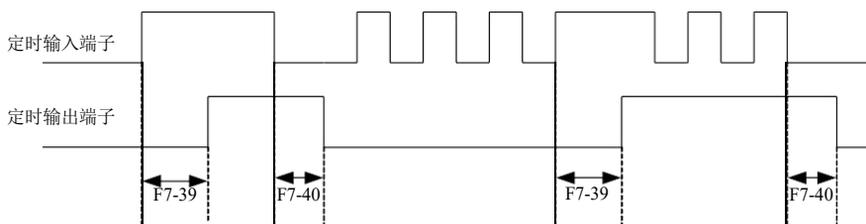
图 5-19. 定时器输入输出动作简图
