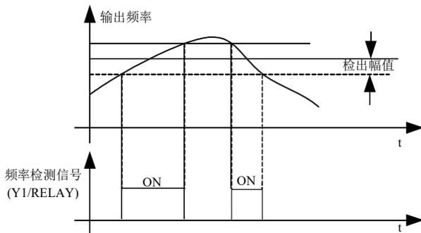
图 5-16. 频率到达检出幅值示意图
