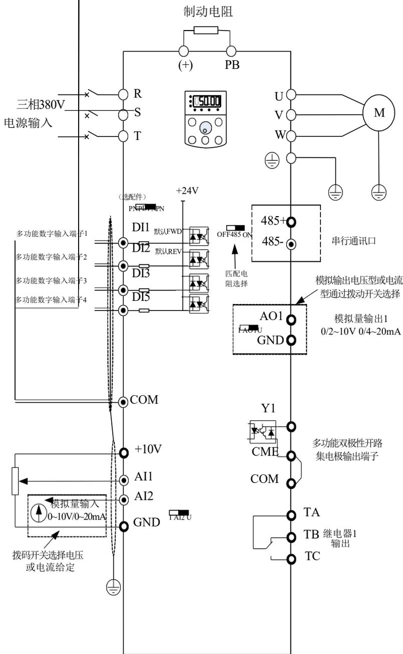
图 3-6. 1.5kW 以下三相变频器
