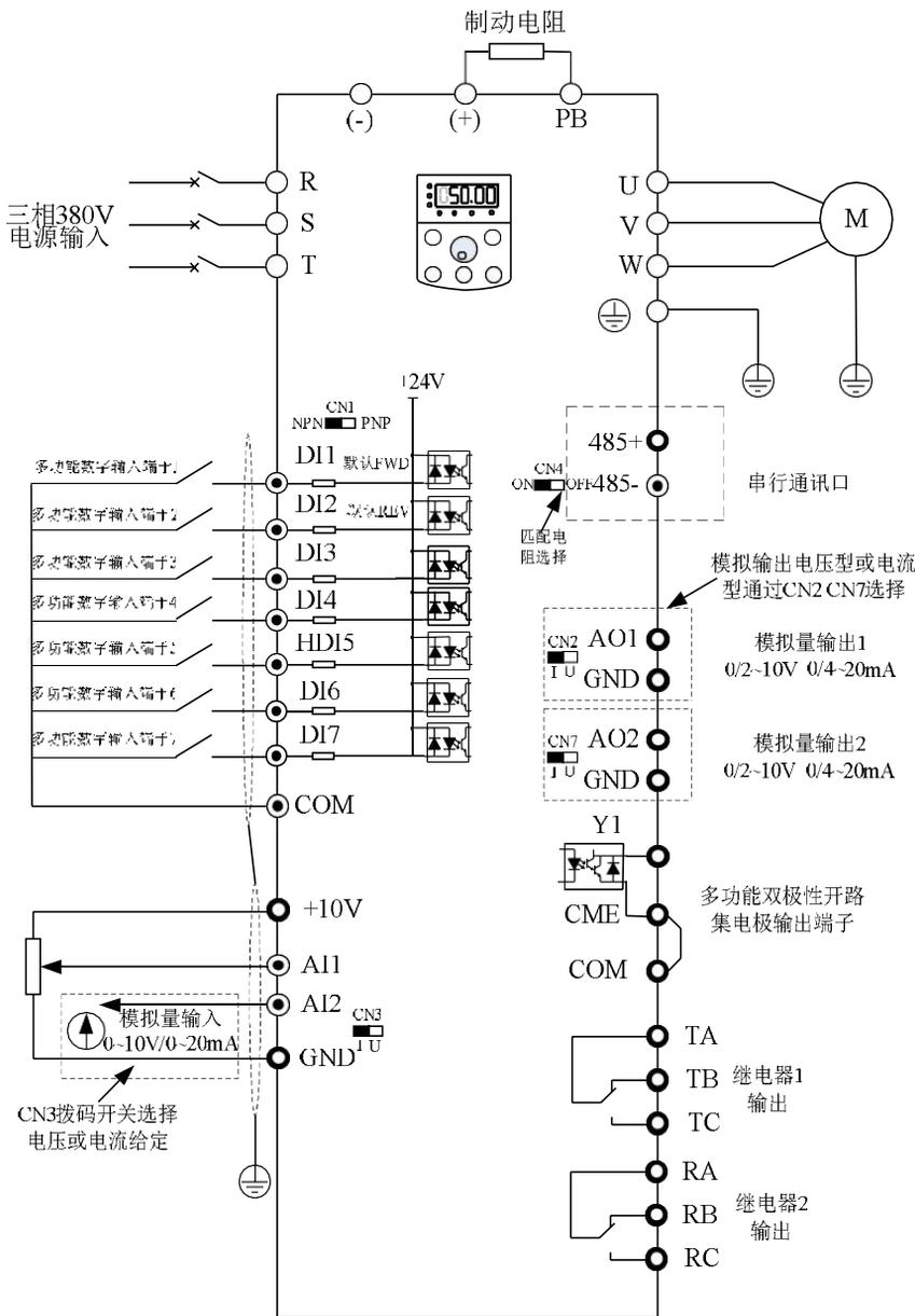
图 3-7. 30kW 以下三相变频器
