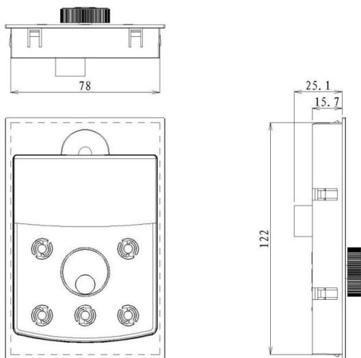
图2-7. 外引键盘带托盘安装尺寸图
