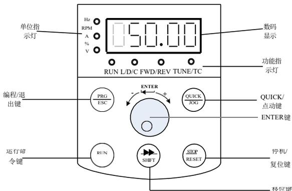
图4-1. 操作面板示意图1(标准配置LED键盘1)
