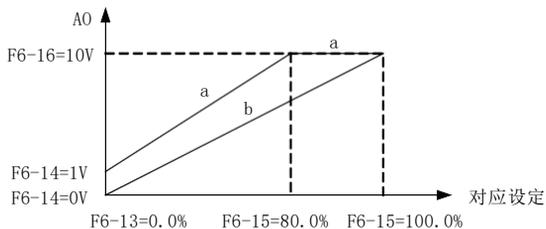
图5-12. 模拟输出上下限对应关系
