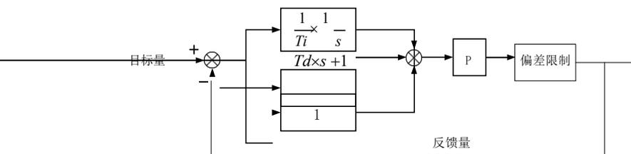
图5-23. 过程PID原理框图
