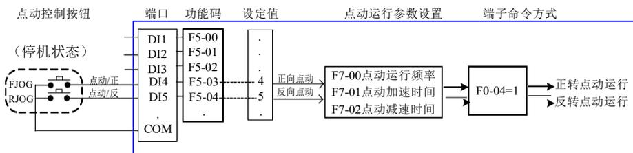
图4-16. DI方式点动参数设定示意图
