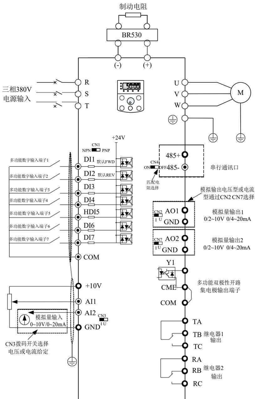
图 3-8. 37kW ~ 55kW 三相变频器
