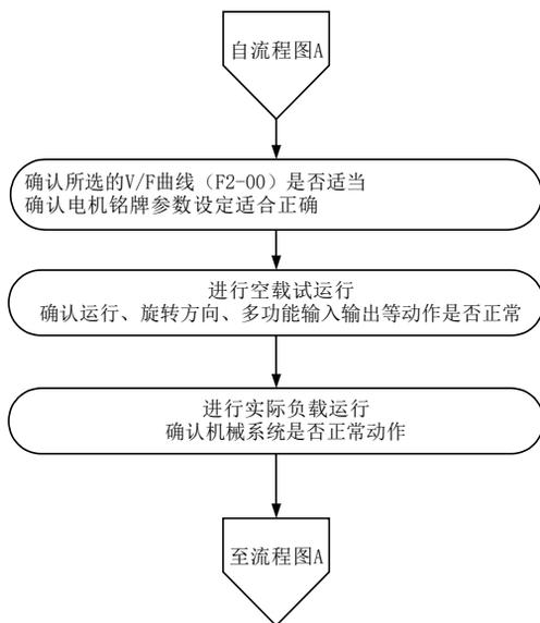
图 4-7. V/F 控制方式运行步骤
