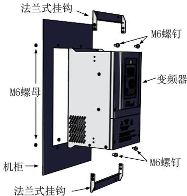
图3-4. BT500变频器钣金结构穿墙式安装图
