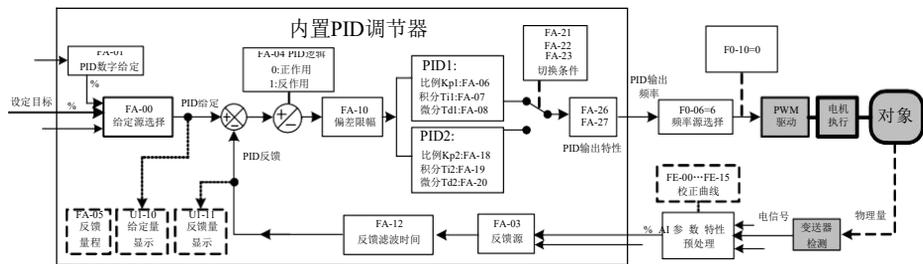
图4-19. 频率闭环控制示意图
