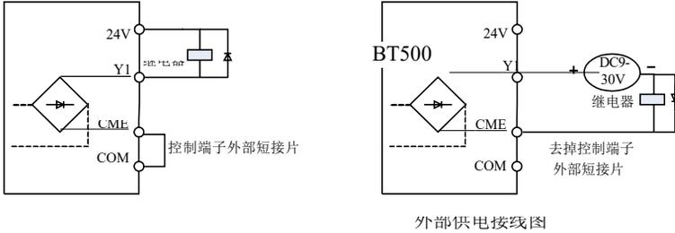
图3-12. 数字输出端子Y1接线示意图
