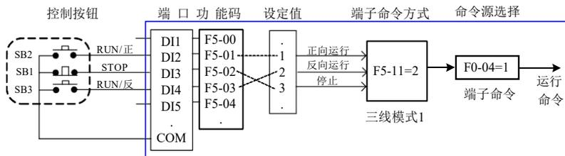
图4-9. 端子控制启停示意图
