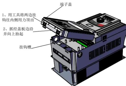
图3-5. 塑胶外壳端子盖拆卸图
