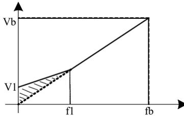
V1:手动转矩提升电压    Vb:最大输出电压
