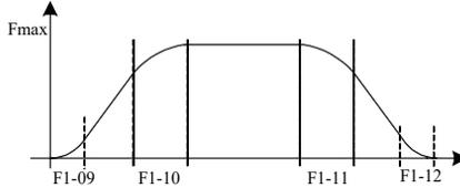
图 5-3. S 曲线加减速示意图
