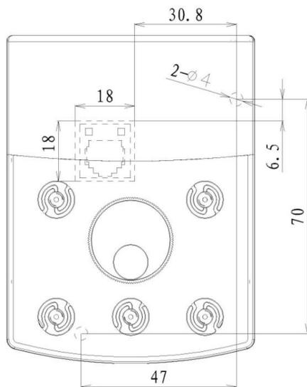
图2-8. 外引键盘不带托盘安装尺寸图
